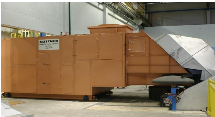
Fig 9. Carro de Carregamento: capô de descarga acoplado a coifa do forno e isolamento acústico.
