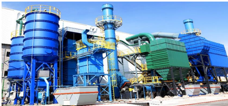
Figura 17. Exemplo de Filtros de Mangas
