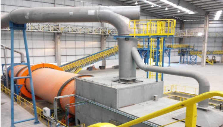
Figura 15. Exemplos de enclausuramentos e captadores
