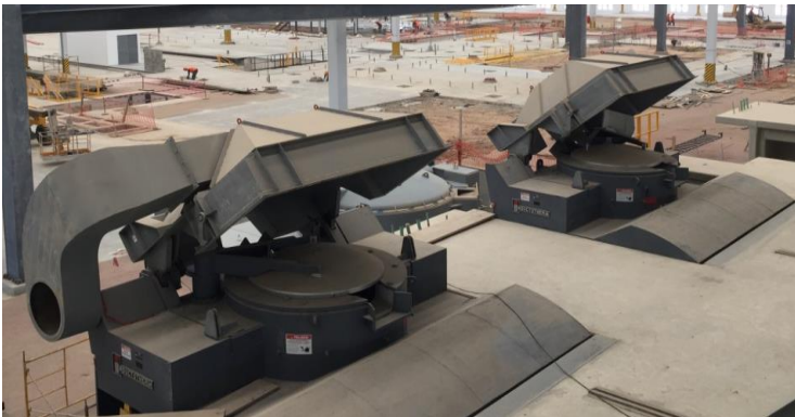
Figura 16. Exemplo de coifas para fornos
