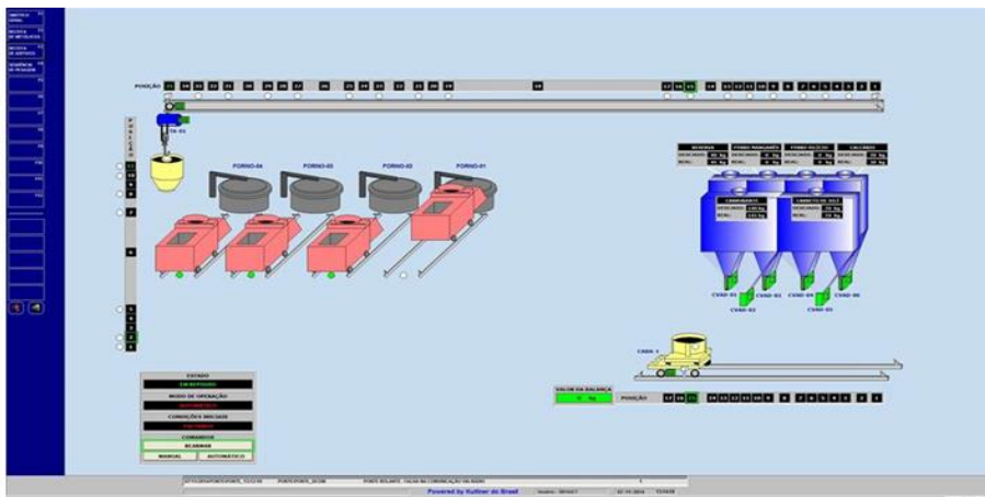
Figura 6. Exemplo de tela de um Sistema Supervisório
