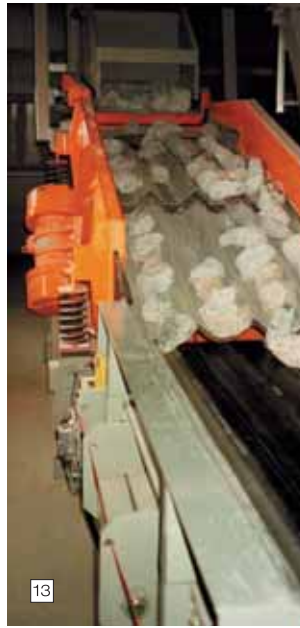
16 + 20 Unwuchtrinnen in staubdichter Ausführung Dustproof unbalance motor feeders
