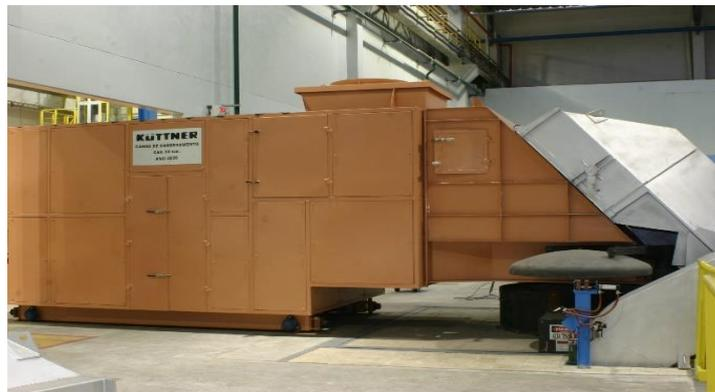
**Figura 9.** Carro de Carregamento: capô de descarga acoplado a coifa do forno e isolamento acústico.
