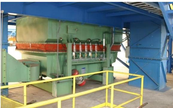
**Figura 12.** Resfriador Kuttner de Leito Fluidizado
