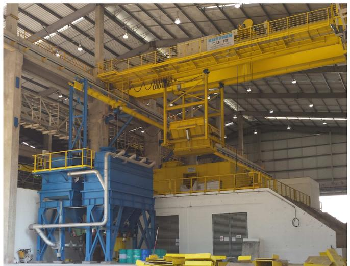
*Foto 3: Sistema automático de adição de ligas*
