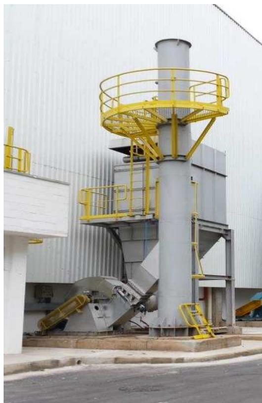
**Foto 12:** Sistema de despeiramento da rebarbação
