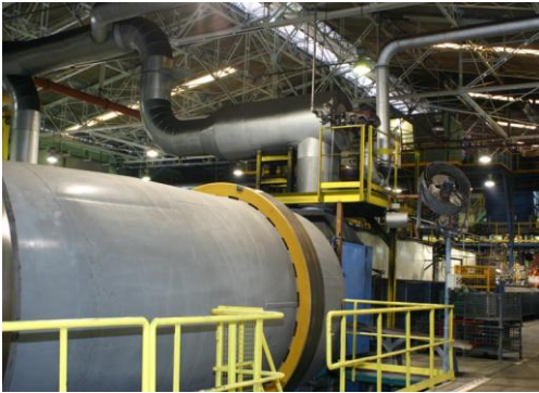
Captação em tambor de desmoldagem e resfriamento (Sist. de areia)
