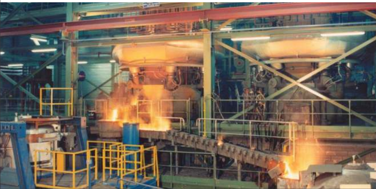
Forno cubilô - Shuttle Corrida de vazamento
