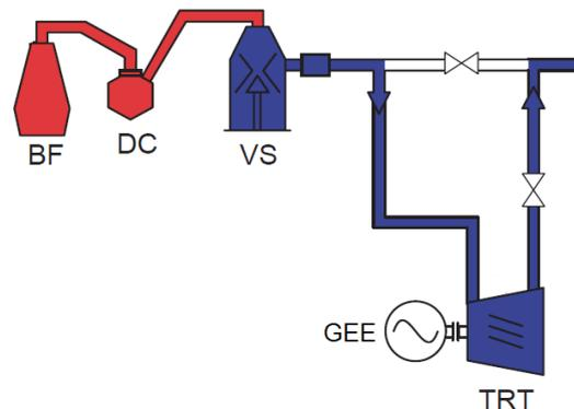
Figura 1. Fluxograma Esquemático da Instalação da TRT.
