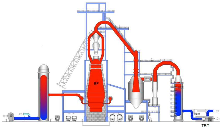
Figura 2. Desenho Esquemático da Instalação da TRT.
