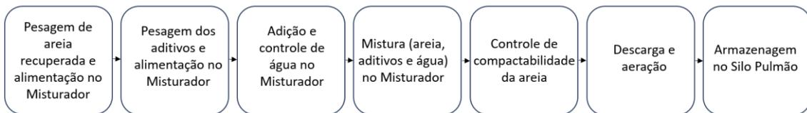
Figura 3. Diagrama de Blocos – Preparação de Areia
